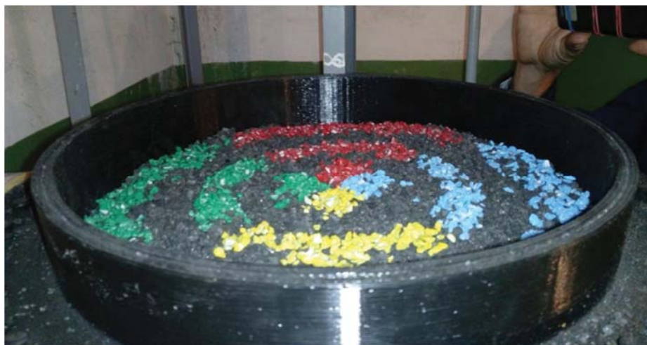
Рис. 2. Приклад використання пофарбованого коксу поміщеного в різні зони на поверхні коксу в УСГК
