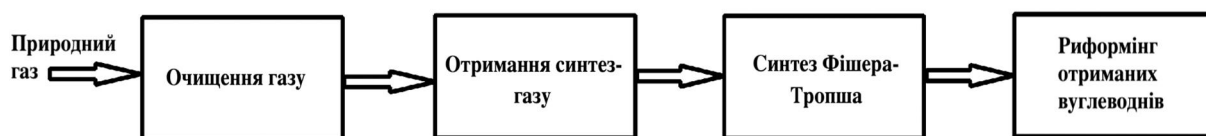
Рис. 1. Основні етапи синтезу рідких вуглеводнів з газу [2].
